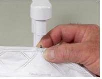
ステップ 5: 次に、PortaPunch™ のレバーア ームを押し下げて、プッシュナ ットをマスクを通って突き出た 露出部分に噛み合わせて、でき るだけしっかりと押します。
