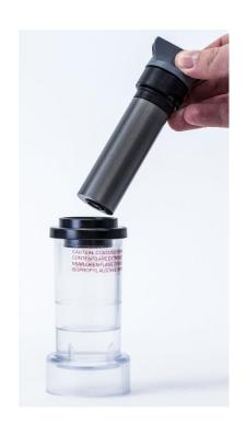
11. アルコールカートリッジを PortaCount™ フィットテスターのカート リッジキャビティに挿入します。軽くスライドさせると挿入されま すので、無理に差し込まないでください。完全に挿入される段階に なったら、アルコールカートリッジが所定の位置にロックされるま で強くひねります。
