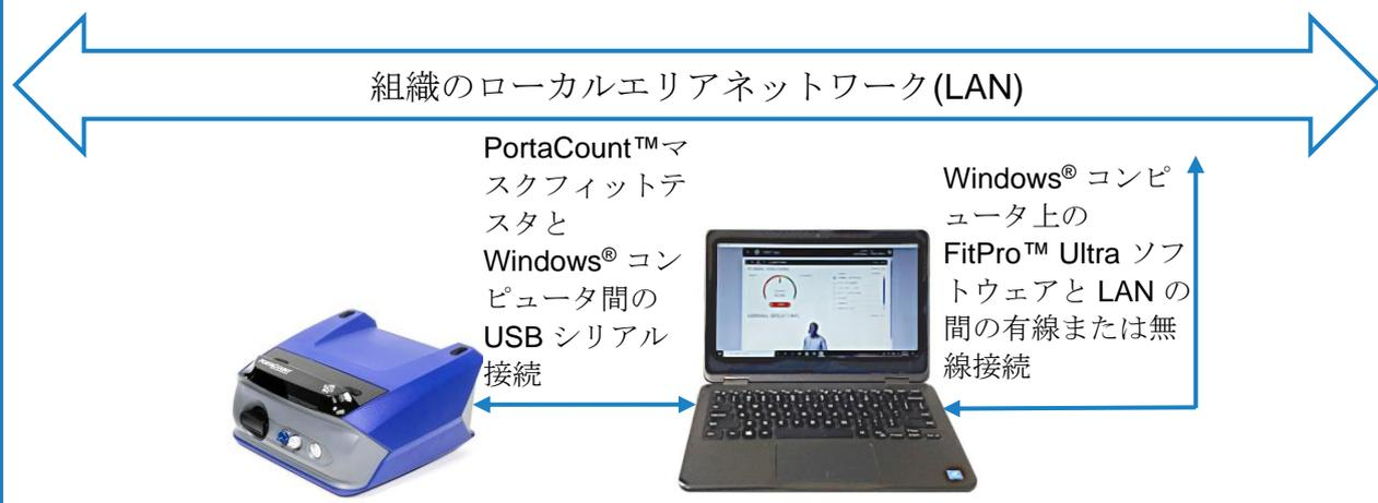
イーサネット または Wi-Fi® 経由で LAN に接続された Windows® コンピュータ、USB シリアル経由でコンピュータに接続された PortaCount™ マスクフィットテスト、Wi-Fi® 直接 経由で PortaCount™ マスクフィットテストに接続されたオプションの Windows® コンピュータ (FPU Client)。
