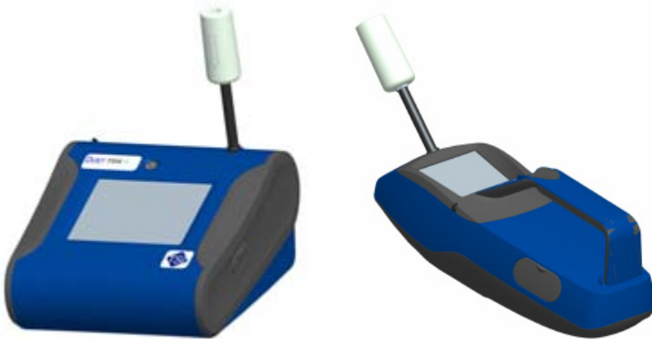
Abbildung 4-1: Befestigung des Nullfilters am Einlass
