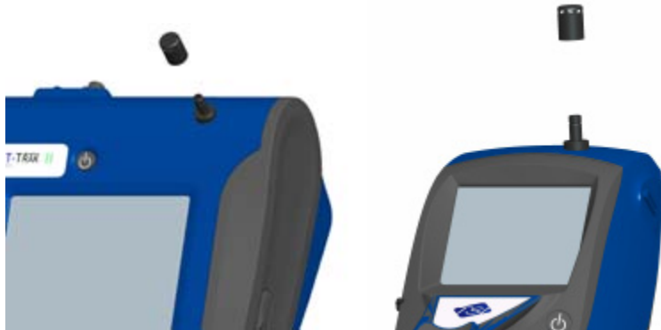
Abbildung 2-3: Aufsetzen der Einlasskappe
