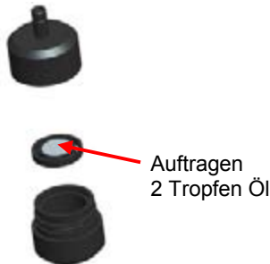
Abbildung 4-4: 2 Tropfen Öl auf die Impaktorplatte auftragen
