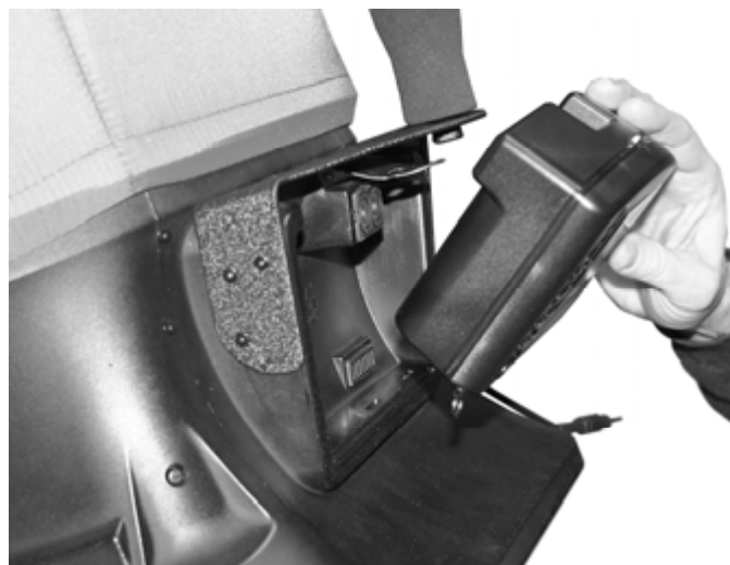
Abb. 8: Einbau des Mikromanometers in die Haubenbasis
