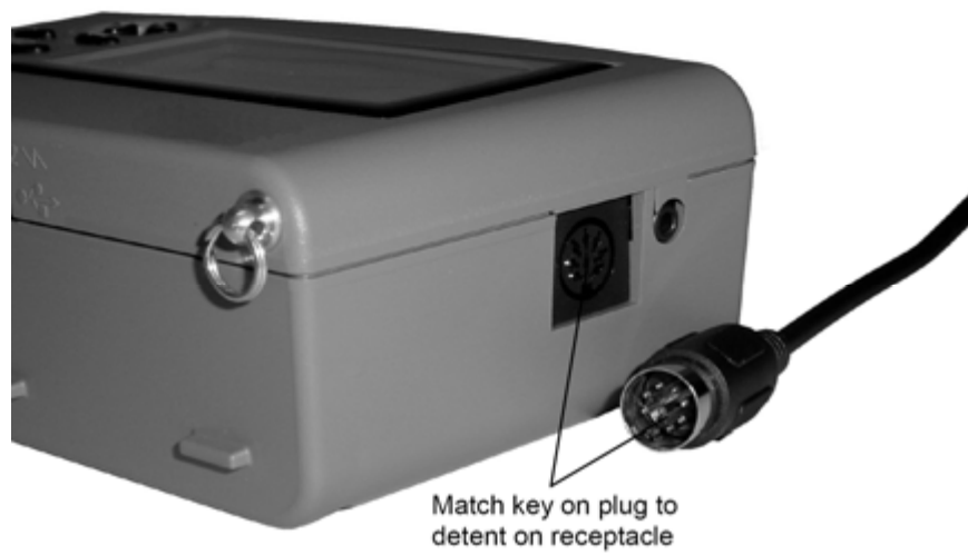
Abb. 11: Stecker für die Temperatursonde bzw. Sonde für Temperatur/Feuchte
