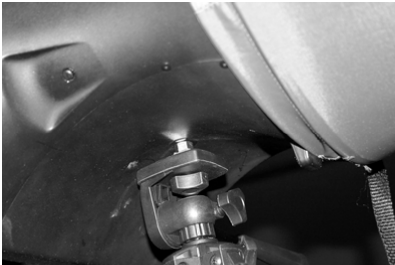
Abb. 25: Montage der Basis auf dem Stativ
