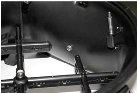
Abb. 23: Anbringung des Gewindestücks an der Rückseite der Haubenbasis
