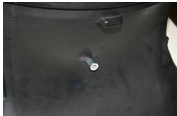
Abb. 23: Anbringung des Gewindestücks an der Rückseite der Haubenbasis
