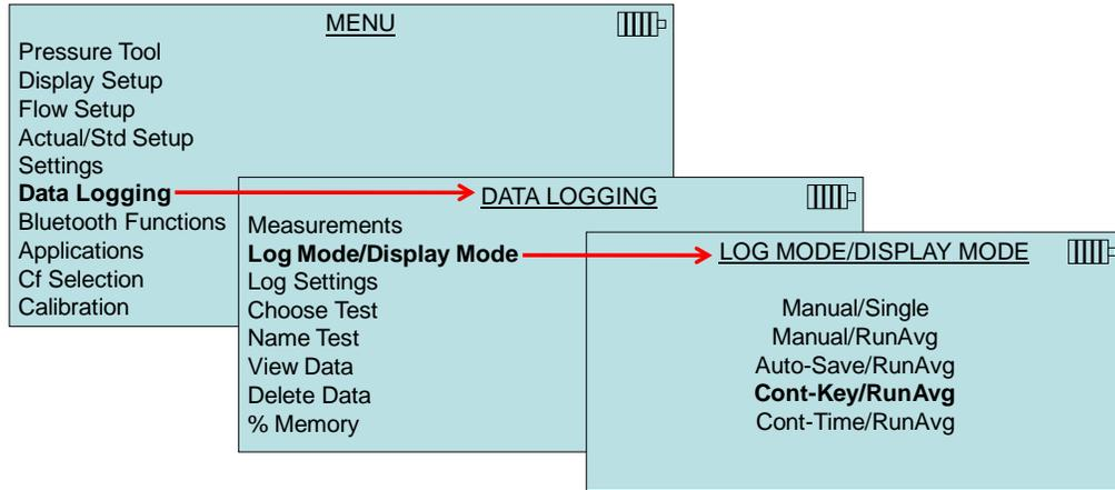
Cuando se establece **Cont. key**, el intervalo de registro se puede ajustar. Utilice las teclas de flecha para hacer los cambios y luego pulse la tecla **↵** para Aceptar.
