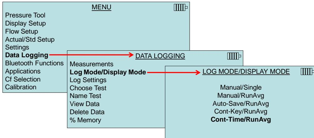
Cuando se establece **Cont-time**, el intervalo de registro y la longitud de prueba se pueden ajustar.
