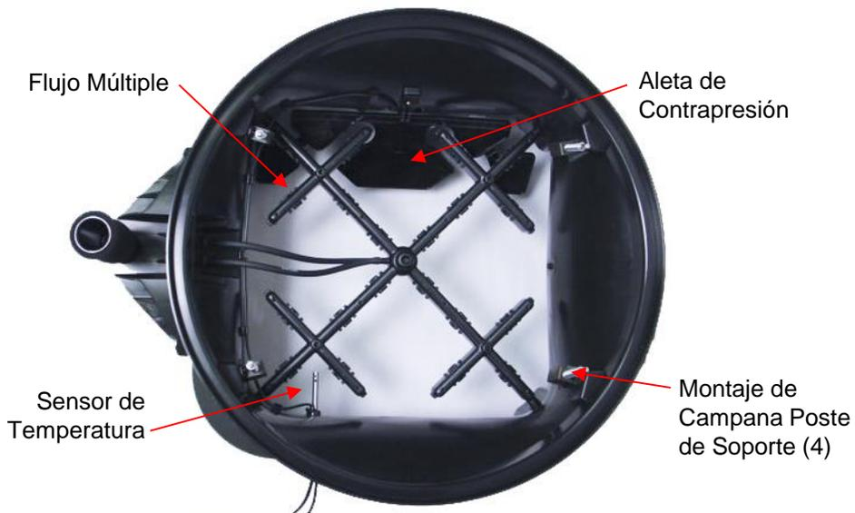
**Figura 4: Características del EBT Balometer® Base, Vista Interior**
