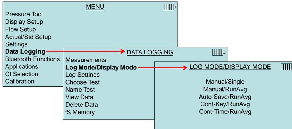
La función **Manual/Single** es una lectura única que necesita ser guardada o desechada por el usuario manualmente. El medidor EBT mostrará ---- y **READY**. Cuando se pulsa la tecla **READ**, el equipo comenzará a tomar una lectura con una duración basado en el **Time Constant setting**. Cuando la cuenta regresiva finalice, se mostrará una lectura.
