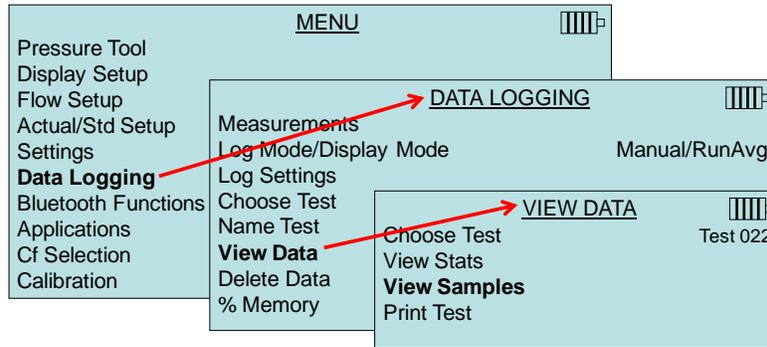
Utilice las teclas de flecha < y > para ver muestras de todos los parámetros de medición almacenados en una Prueba ID.
