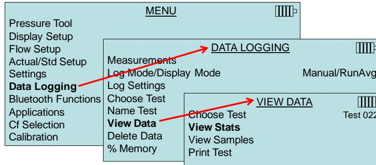
Utilice las teclas de flecha ◀ y ▶ para ver las estadísticas de todos los parámetros de medición almacenados en un ID de prueba.
