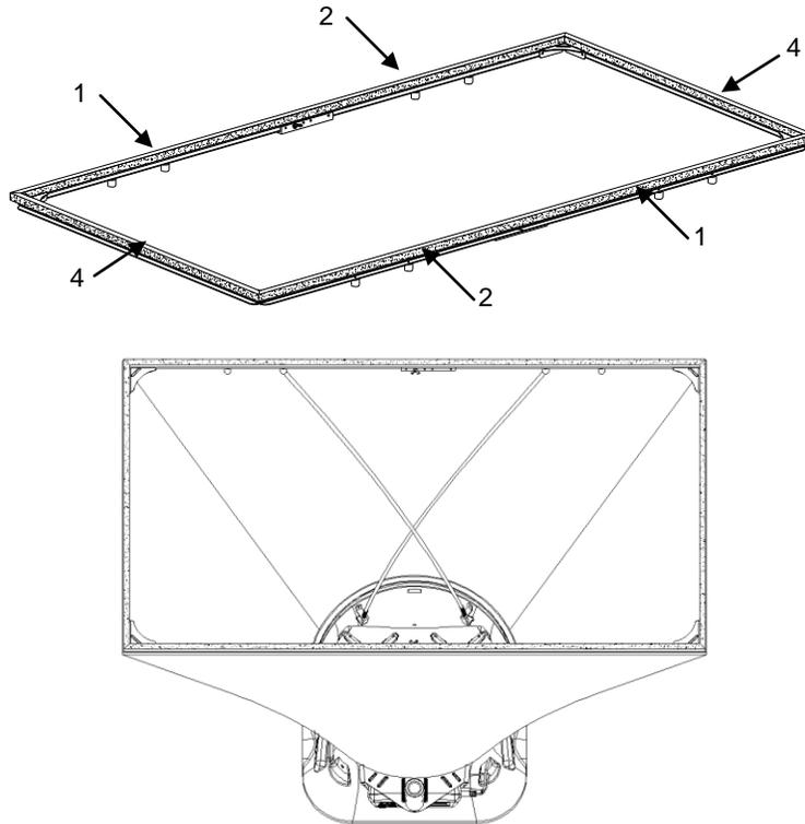
**Figura 18: Marco de campana de 2 ft × 4 ft (610 mm × 1220 mm). Los postes de soporte siempre se cruzan en forma de pares en la parte delantera y trasera de la campana de tela. Para los postes de soporte de 2 ft × 4 ft (610 mm × 1220 mm), se insertan en las ubicaciones del interior de la virola.**
