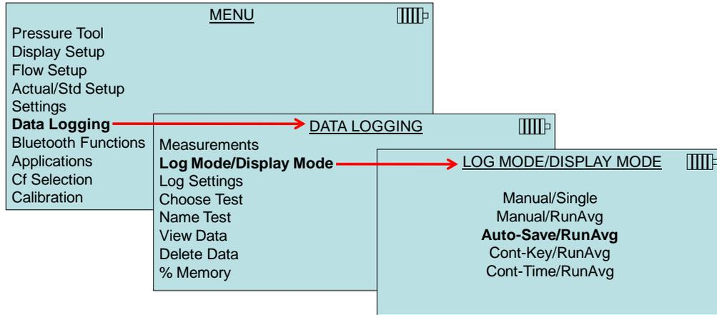
Cuando se establece en **Auto-Save/RunAvg**, el tiempo de muestra se puede ajustar. El Tiempo de muestra es el periodo de tiempo sobre el cual se promediara la muestra. Pulse aceptar ← después de usar las teclas de flecha para hacer los cambios.
