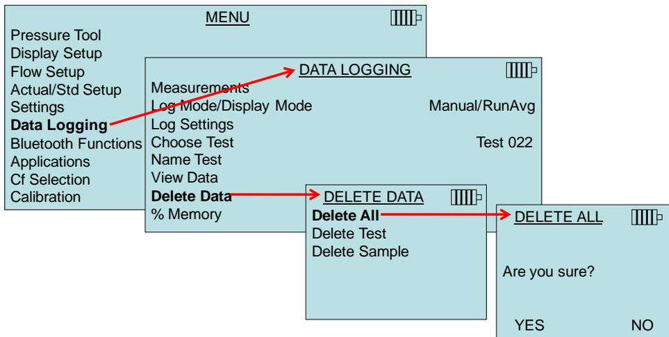
**Delete Test** se borran los datos almacenados en una Prueba de ID individual seleccionada por el usuario.
