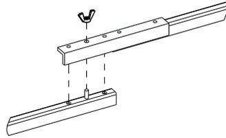
**Figura 22: Lado del Marco Ensamblaje del Acoplador**
