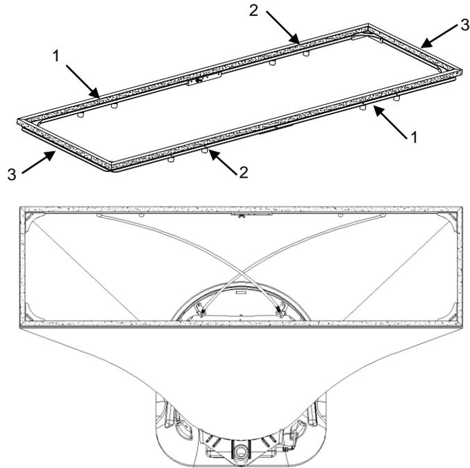
**Figura 17: Marco de campana de 1 ft x 4 ft (305 mm x 1220 mm). Los postes de soporte siempre se cruzan en forma de pares en la parte delantera y trasera de la campana de tela. Para los postes de soporte de 1 ft x 4 ft (305 mm x 1220 mm se insertan en las ubicaciones fuera de la virola.**
