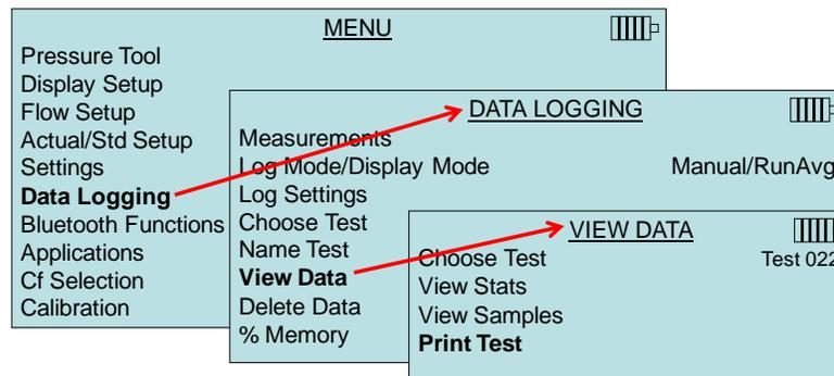
El medidor puede enviar estos datos a la impresora inalámbrica opcional Modelo 8934 o PC capaz de comunicarse con Bluetooth. Para usar el comando **PRINT**, comunicaciones Bluetooth deben establecerse entre el medidor y la impresora inalámbrica Modelo 8934 o la PC configurada con comunicaciones Bluetooth.
