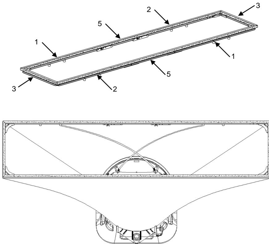
**Figura 19: Marco de campana de 1 ft x 5 ft (305 mm x 1525 mm). Los postes de soporte siempre se cruzan en forma de pares en la parte delantera y trasera de la campana de tela. Para los postes de soporte de 1 ft x 5 ft (305 mm x 1525 mm), se insertan en las ubicaciones del interior de la virola.**
