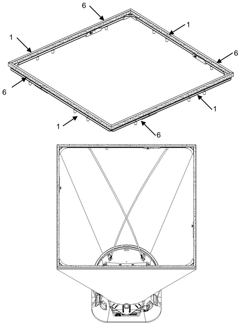
**Figura 20: Marco de campana de 3 ft x 3 ft (915 mm x 915 mm)** Los postes de soporte siempre se cruzan en forma de pares en la parte delantera y trasera de la campana de tela. Para los postes de 3 ft x 3 ft (915 mm x 915 mm) se insertan en las ubicaciones fuera de la virola.
