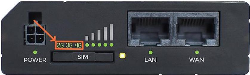
**Figure 16 :** DEL d'état de connexion
