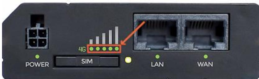
**Figure 17** : DEL d'intensité du signal
