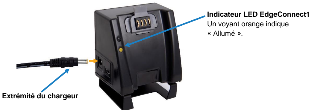
Figure 2-5 : Connexion du chargeur au EdgeConnect1 (utilisez EdgeDock1 pour les modèles EG3, EG4, EG5)
