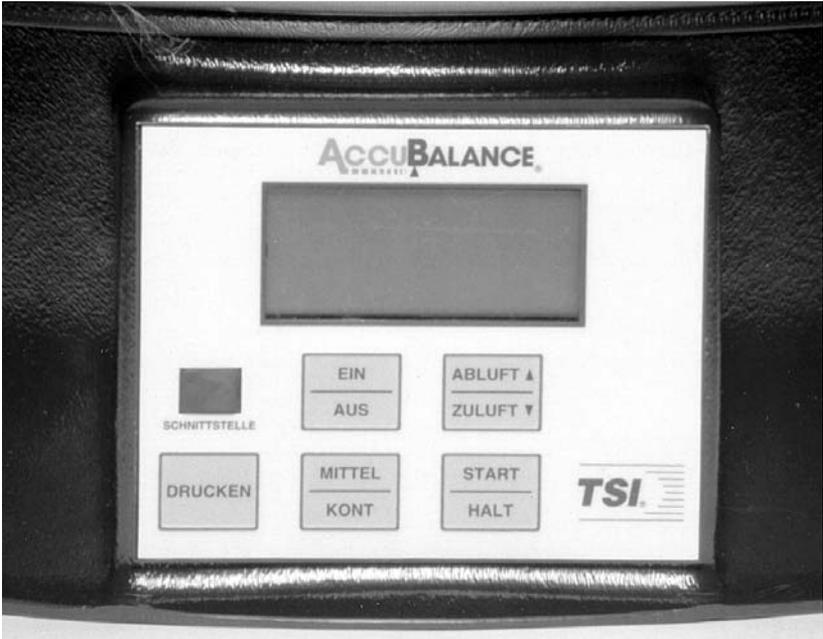
**Bild 3. Membrantasten des Gerätes**
