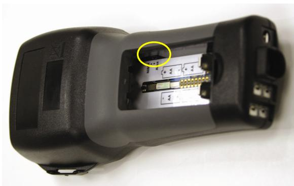
Figura B-1 Collocazione dell'interruttore DIP
