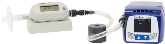
TSI 4146 流量计 (单独出售) 被用于校正流量设置
