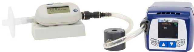
TSI 4146-debietmeter (los verkrijgbaar) voor het kalibreren van de debietinstelling
