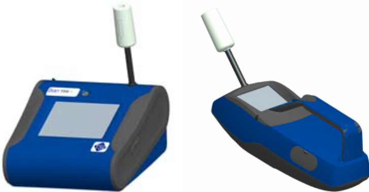
Abbildung 4-1: Befestigung des Nullfilters am Einlass
