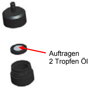
Abbildung 4-4: 2 Tropfen Öl auf die Impaktorplatte auftragen
