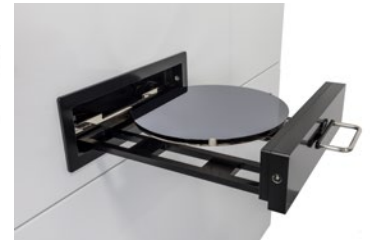
すべてのバージョンで200 mmと300 mmウェハへの塗布が可能です。
