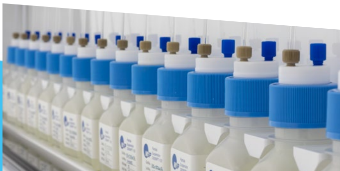
最大16種類のパーティクルボトルをセットしておくことが出来ます。
