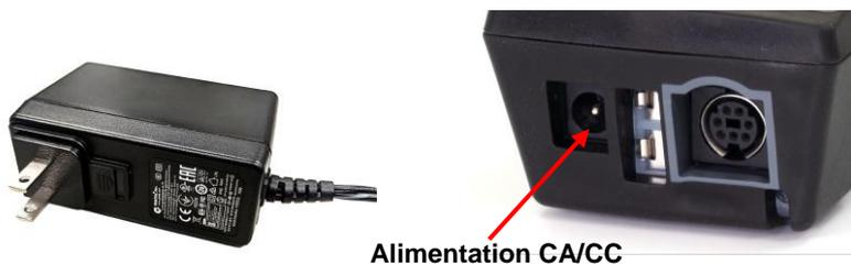
Lorsque l'alimentation CA/CC est connectée, l'instrument **s'allume** automatiquement. Pour éteindre l'instrument, débranchez l'alimentation CA/CC. Si des piles sont installées, appuyez sur le bouton d'alimentation pendant 3 secondes.
