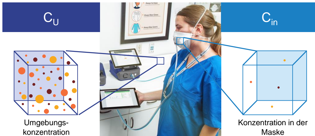
Abbildung 2: Messungen bei der quantitativen Dichtsitzprüfung
