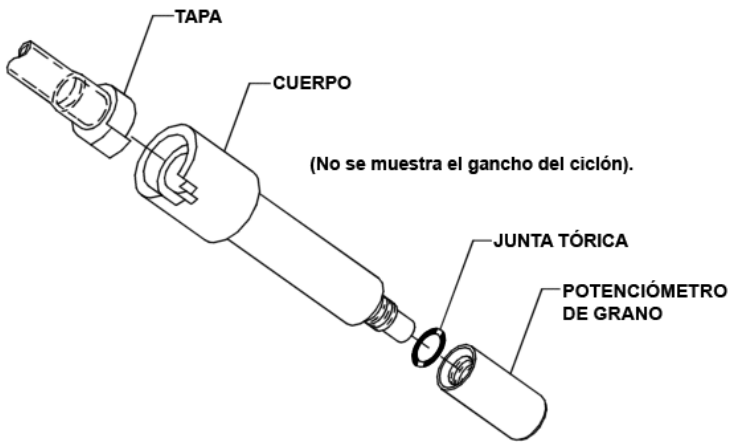
Vista expandida del ciclón de nilón Dorr-Oliver de 10 mm
