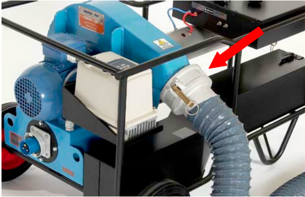
Figure 1 Connecteur du verrou à came et conduite de test montés sur la sortie du ventilateur
