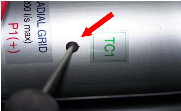
Figure 2 Emplacement de montage du thermocouple (T1)
