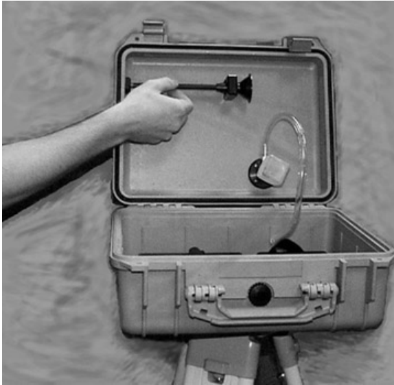
Abb. B-3: Ausbau des Einlasses aus der Halteklammer
