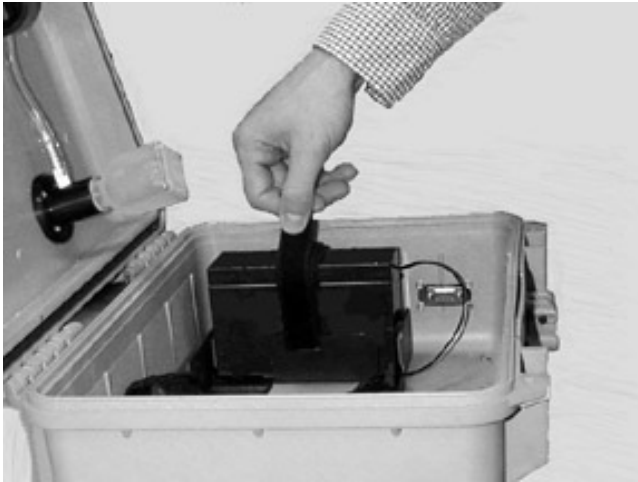
Abb. B-12: Fixierung des Akkus
