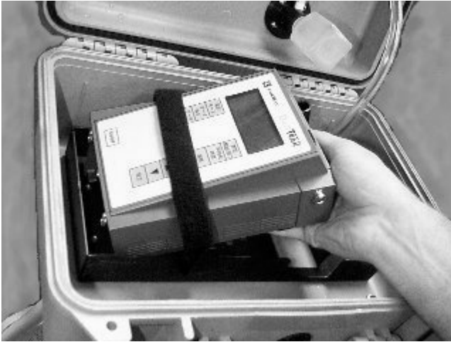
Abb. B-8: Einschub des DUSTTRAK in die Halterung
