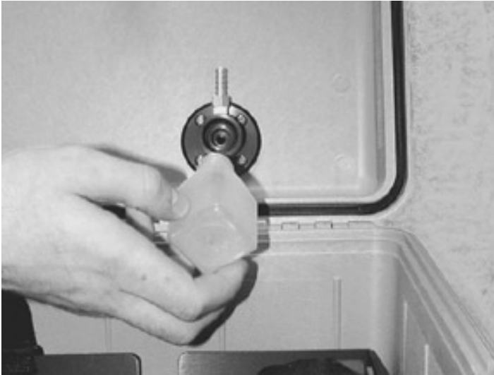
Abb. B-5: Montage der Wasserauffangflasche
