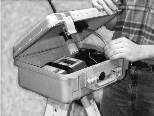
Abb. B-10: Knicken des Schlauchs vermeiden
