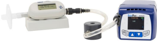
مقياس التدفق TSI 4146 (المباع بشكل منفصل) المستخدم لمعايرة إعداد التدفق
