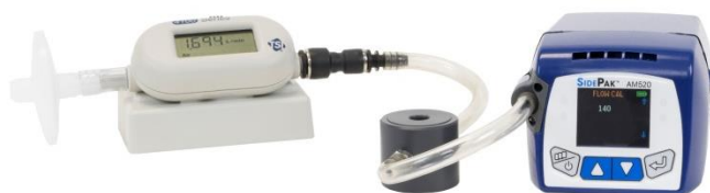
Débitmètre TSI 4146 (vendu séparément) utilisé pour étalonner le débit
