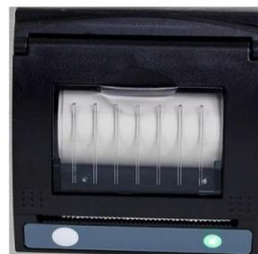
Ao instalar um novo rolo de papel, a extremidade da etiqueta deve estar na parte inferior do rolo e puxada pela porta da impressora.
