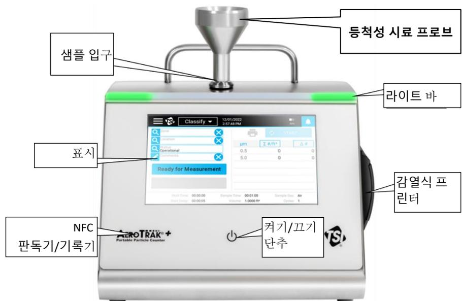
터치 스크린 디스플레이는 직관적인 그래픽 사용자 인터페이스(GUI)를 제공한다. LED 표시줄은 기기가 켜져 있는 시기를 나타내며 샘플링 중 상태 정보를 제공한다. 패널 왼쪽의 AeroTrak®+ Portable Particle Counter 레이블 아래에 비접촉 통신을 제공하는 NFC(Near-Field Communication) 판독기/기록기가 있습니다.
