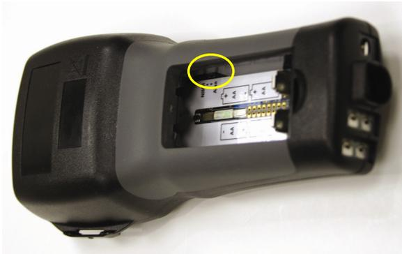
Abbildung B-1: Lage des DIP-Schalters
