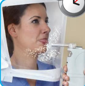
Répétez trois fois au total. Si aucun goût n'est détecté après trois essais, la personne examinée ne peut pas détecter la solution. Il faut utiliser un autre type de solution ou un autre appareil pour le « fit test »
