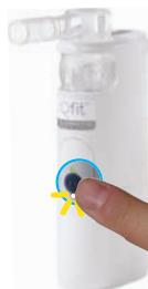
Appuyez sur le bouton de contrôle jusqu'à l'apparition d'une lumière jaune.
