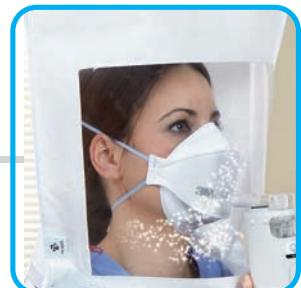
Insérez le bec du nébulisateur dans l'ouverture du capuchon en vue du « Fit test » de 7 minutes.
