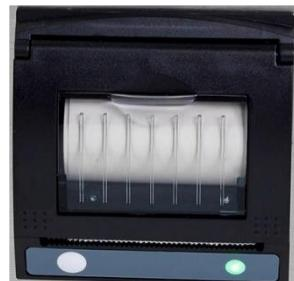
Ao instalar um novo rolo de papel, a extremidade da etiqueta deve estar na parte inferior do rolo e puxada pela porta da impressora.
