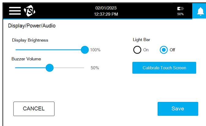
Use os controles deslizantes para ajustar o Brilho da tela e o Volume do zumbido. A barra de luz pode ser ligada ou desligada. Se a capacidade de resposta da tela sensível ao toque estiver fraca, ela poderá ser calibrada para tentar melhorar o desempenho. Pressione o botão **Calibrate Touch Screen** (Calibrar tela de toque) e siga os prompts.
