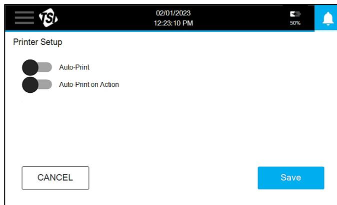
Ativar a **Auto-Print** (Impressão Automática) imprimirá automaticamente o registro de amostra no final da amostragem. Ativar a opção **Auto-Print on Action** (Imprimir automaticamente ao executar) uma ação imprimirá automaticamente o registro de amostra no final da amostragem somente se o limite de ação tiver sido excedido.
