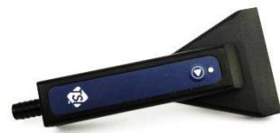
Conectar a sonda do scanner de filtro eletrônico permite iniciar e parar amostras da cabeça da sonda. Além disso, o alarme para exceder um determinado limite de concentração de partículas pode ser ouvido na sonda, bem como do instrumento.
