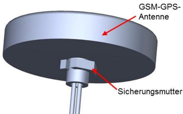
6. GSM-GPS-Antenne gemäß Abbildung befestigen. **Weiter mit Schritt 8, wenn Ihr Gerät über einen Hitzeschutz verfügt.**
